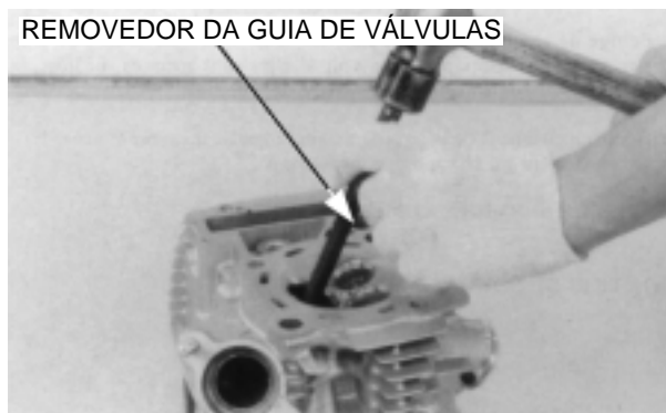
EXTRATOR/INSTALADOR DA GUIA DAS VÁLVULAS GUIA
